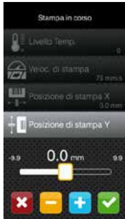
Offset di stampa Y Cursore per regolazione rapida, tasti ± per regolazione precisione
