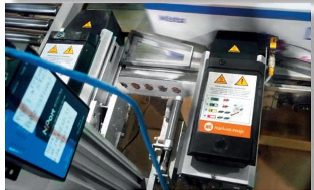
**I 12 marcatori 5800 installati presso il Pastificio Pallante permettono di stampare la tipologia di prodotto, il numero di lotto, la data di scadenza e il codice a barre EAN 128.**
